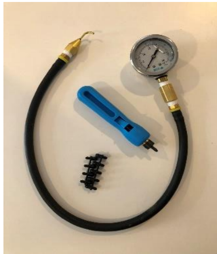
Équipements pour la mesure de la pression (tube de Pitot) (Source : Agropomme).
